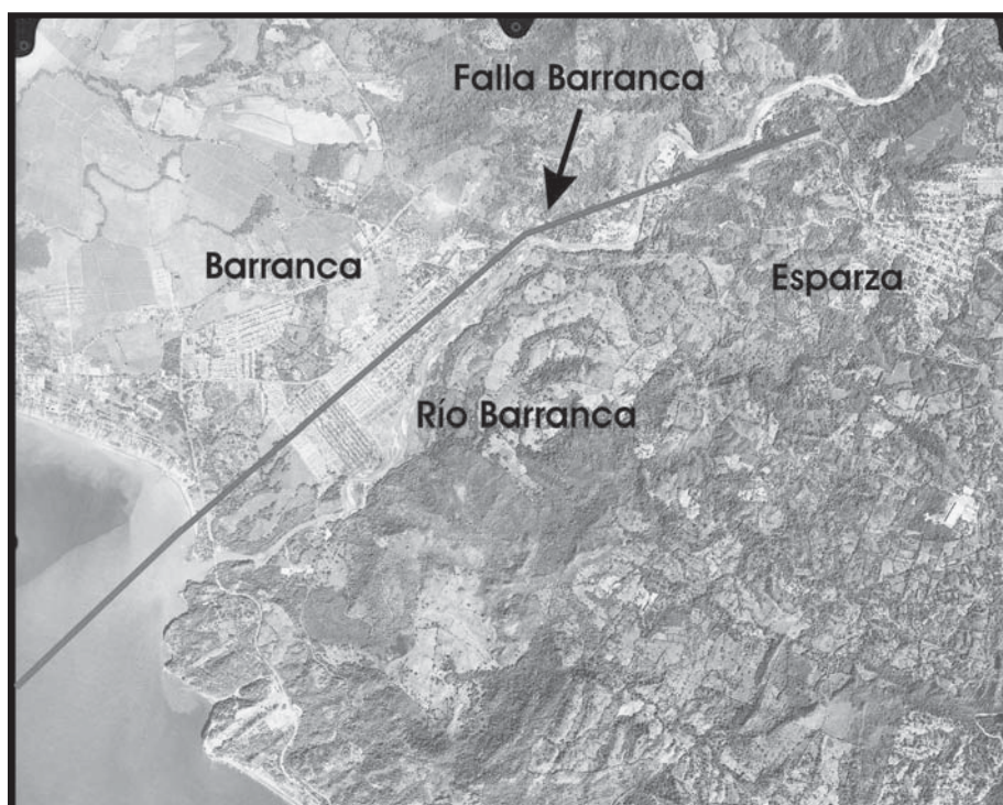
Figura 3. Falla Barranca. Esta es una importante falla que atraviesa el Golfo de Nicoya y se interna en el continente pasando por la localidad de Barranca. Es visible bajo el puente sobre el río Barranca en la Carretera Interamericana. Esta falla pudo haber sido la responsable del terremoto de Cóbano.
